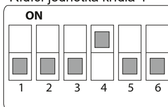
Adresa 4 Řídicí jednotka křídla 4
