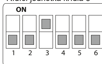
Adresa 3 Řídicí jednotka křídla 3
