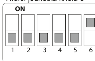
Adresa 6 Řídicí jednotka křídla 6
