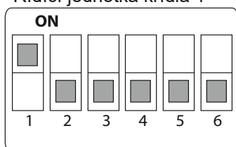
Adresa 1 Řídicí jednotka křídla 1
